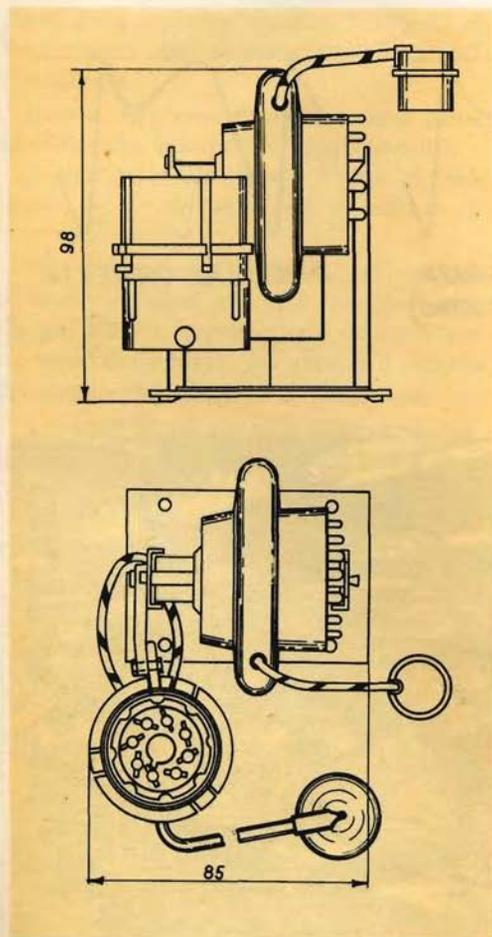
Fig. 1 - Dimensioni d'ingombro del trasformatore M/389.
