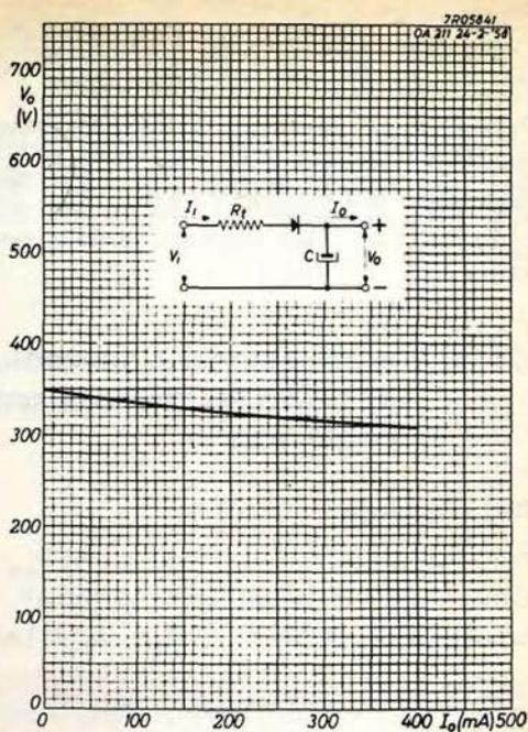
Fig. 4 - Curva di regolazione della tensione.
