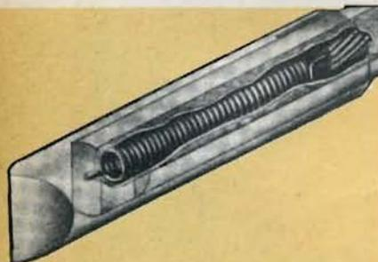
*La punta staccabile, in lega di nichel o di rame, viene infilata sopra un tubo di metallo contenente l'elemento riscaldante isolato elettricamente.*
