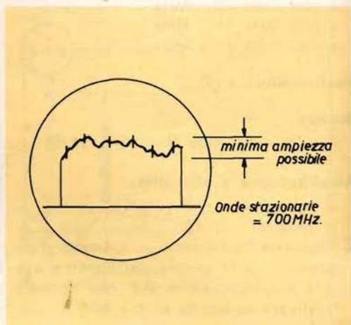
Fig. 6 - Curva oscillografica del controllo del coefficiente di riflessione.
