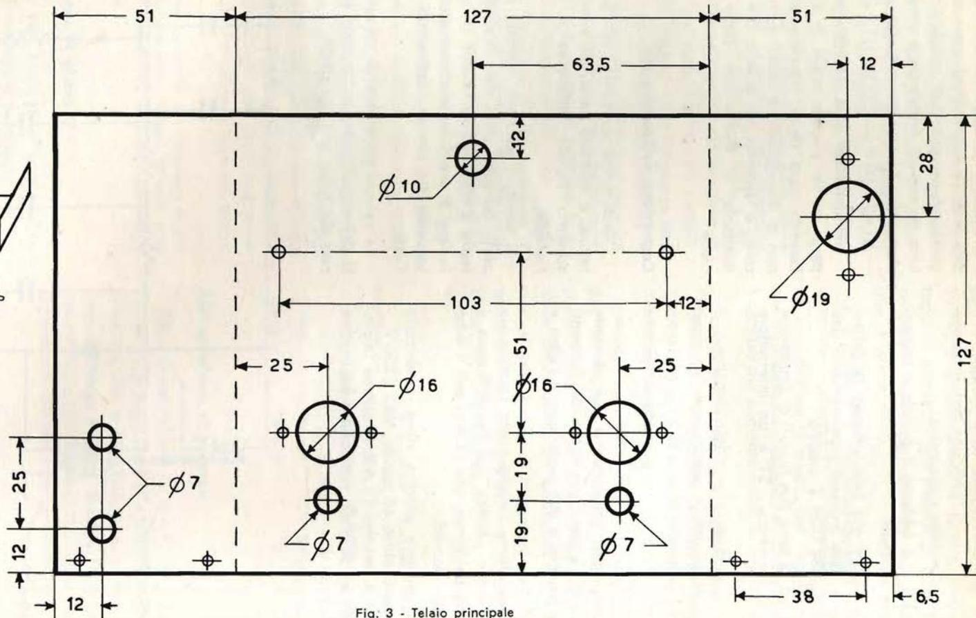
Fig. 3 - Telaio principale
