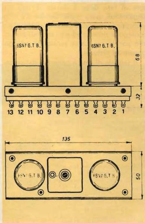
Fig. 2 - Dimensioni d'ingombro del telaio M/387.
