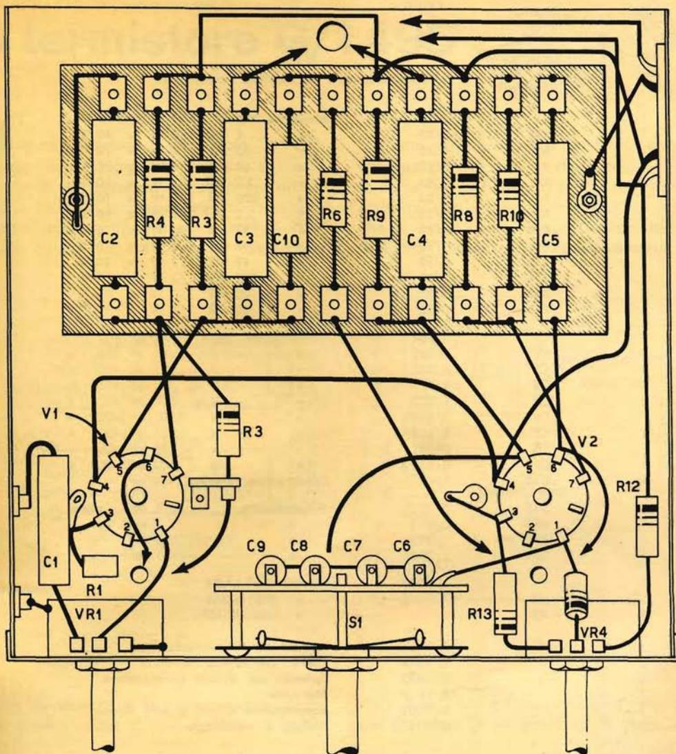
Fig. 7 - Vista inferiore del telaio montato.
