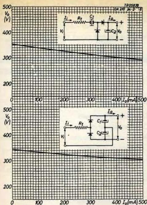
Fig. 3 - Curva di regolazione della tensione.
