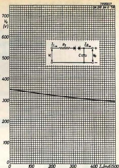
Fig. 2 - Curva di regolazione della tensione.
