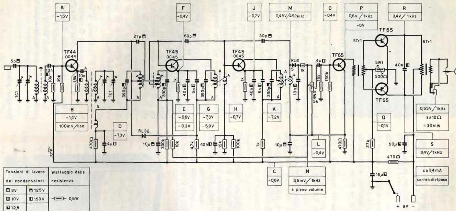
Fig. 1 - Schema di servizio del ricevitore tascabile Siemens T1. Le tensioni di radio frequenza sono state misurate con voltmetro a valvola con 5 pF di capacità d'ingresso. I valori di tensione indicati sono stati misurati con un 1 mV di tensione ai morsetti di antenna. Le tensioni di bassa frequenza sono state misurate con un millivoltmetro di B.F., le tensioni continue con un tester 50.000  $\Omega/V$ .
