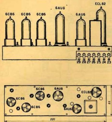
Fig. 3 - Dimensioni d'ingombro del telaio M/386.
