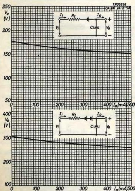
Fig. 1 - Curve di regolazione della tensione.
