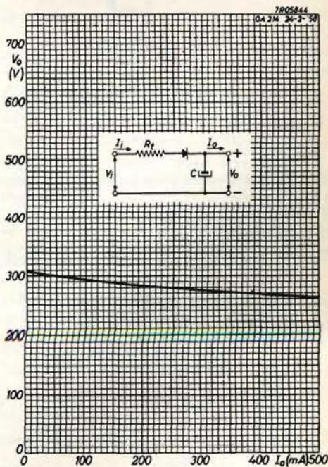
Fig. 5 - Curva di regolazione della tensione.
