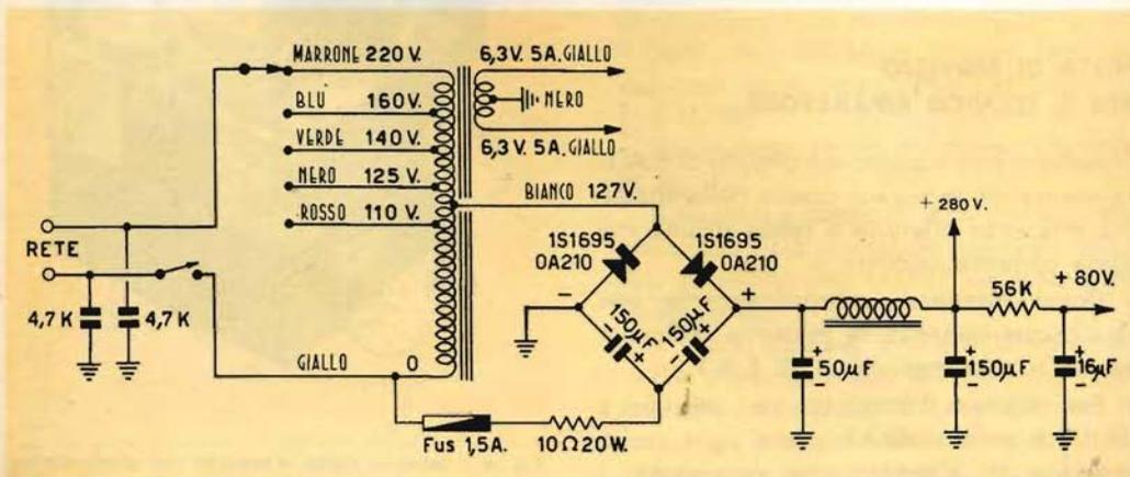
Fig. 3 - Esempio tipico d'impiego del trasformatore M/381.
