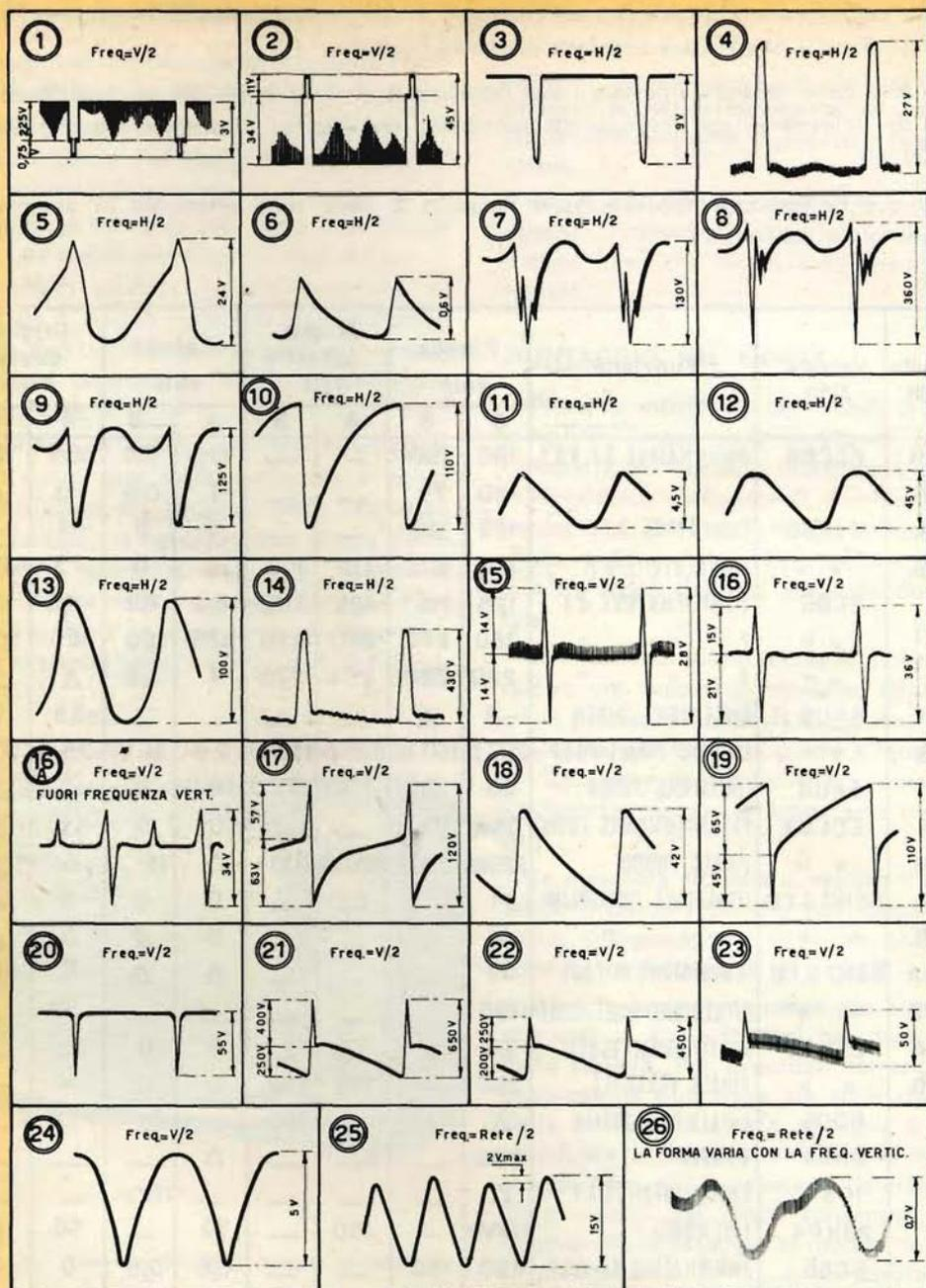
Oscillogrammi che appariranno sullo schermo dell'oscillografo, quando questi verrà inserito in corrispondenza dei punti indicati, nello schema elettrico del televisore, con un numero compreso entro due cerchi concentrici.
