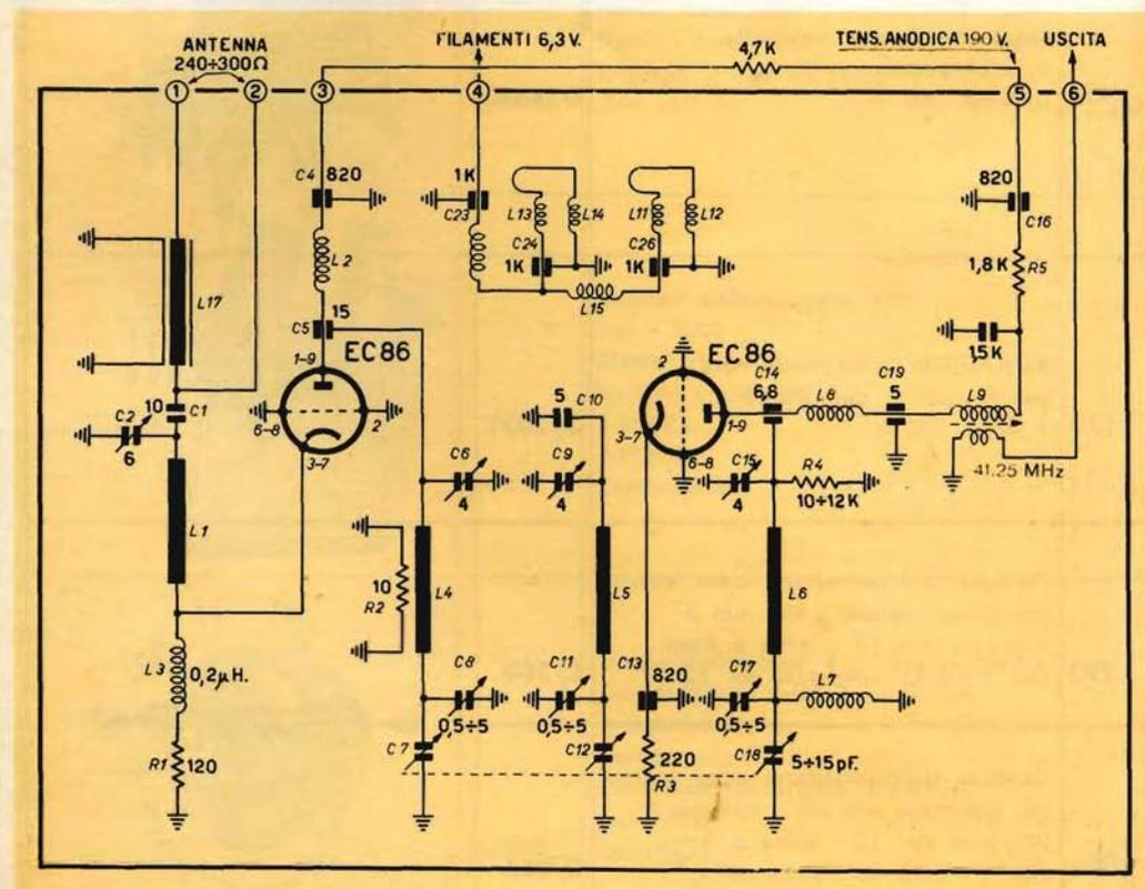
Fig. 2 - Schema elettrico del gruppo U.H.F. M/390.
